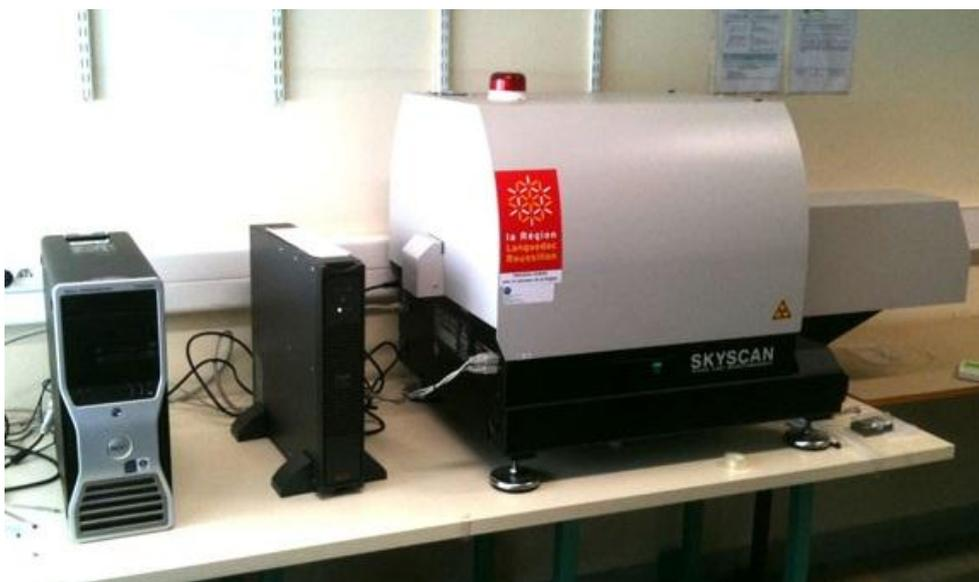
Figure 4.8. Microtomographe RX *in vivo* Skyscan 1076 de la plateforme MRI de l'Université de Montpellier 2.
