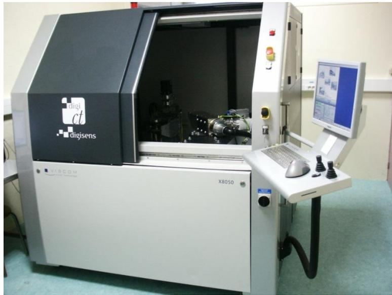
Figure 4.10. Microtomographe Viscom X8050-16 « multi-échelle » de l'Université de Poitiers.
