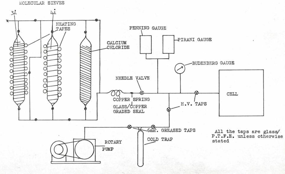
FIG: (4.12) ROUGHING LINE AND GAS DOSING SYSTEM
