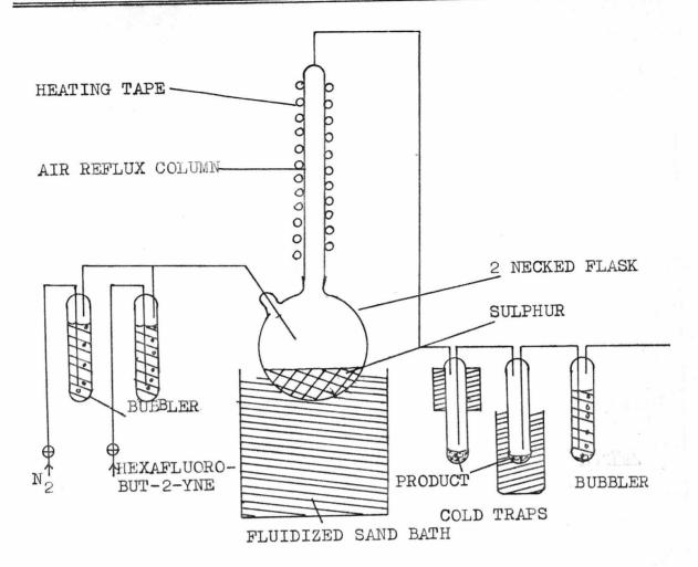
FIG: (3.2) APPARATUS FOR THE PREPARATION OF THE NICKEL COMPLEX
