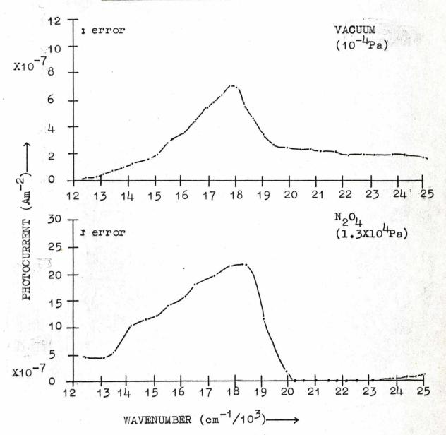
FIG: (6.9) PHOTOCURRENT INTENSITY DEPENDENCE PLOTS FOR PERYLENE-TCNQ IN A VACUUM
